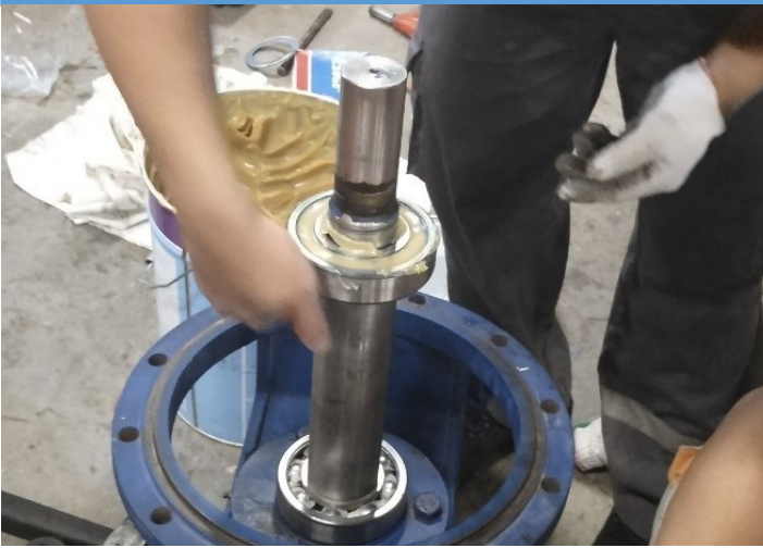
Thực hiện thay thế vòng bi máy bơm sau 1 thời gian vận hành
