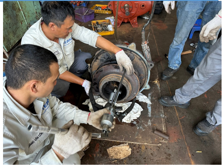
Vạm tháo cánh bơm để thực hiện tổng bảo dưỡng máy bơm
